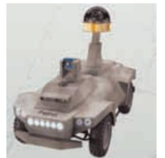
Модель «Трал Патруль-3» представляет собой четырехколесное шасси, оснащенное несколькими камерами. Робот может осуществлять патрулирование по заранее заданному маршруту и вести видеонаблюдение на дистанции до 120 метров.
