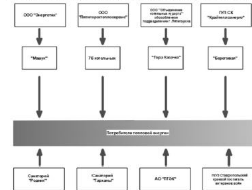
Рис. 2.4. Функциональная схема централизованного теплоснабжения г. Пятигорска
